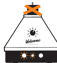
¡Peligro de quemaduras! Jamás dejar colocada la cámara de relleno sobre el VOLCANO
