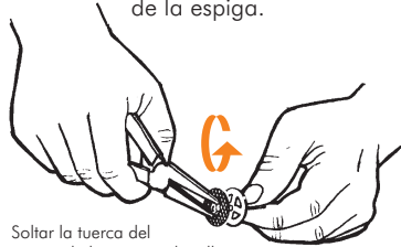
Soltar la tuerca del inserto de la cámara de relleno
